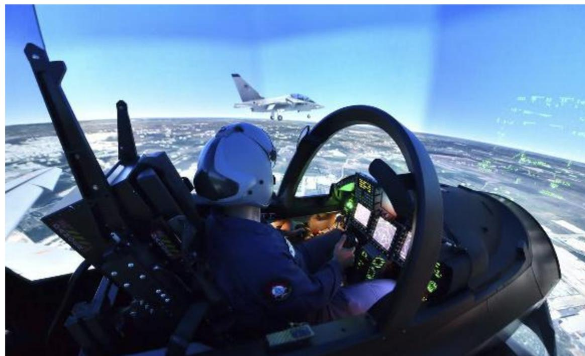
Hmd - Helmet Mounted Display, il casco con il visore che proietta i dati della strumentazione di bordo, e tre simulatori sintetici Part Task Trainer, con visuale di 180°, che riproducono l'abitacolo per addestrare alle procedure di navigazione e alle emergenze. Ma c'è di più.
