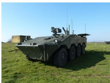
Il **Centauro VBM Porta Mortaio** presenta le stesse caratteristiche di mobilità e versatilità della famiglia Centauro. Sulla piattaforma è installato un mortaio rigato 2R2M da 120 mm che offre numerosi vantaggi in termini di precisione, distanza di fuoco, celerità di tiro, protezione ed ergonomia grazie al sistema di caricamento semi-automatico e degli asservimenti elettro-idraulici per il brandeggio e l'elevazione.
